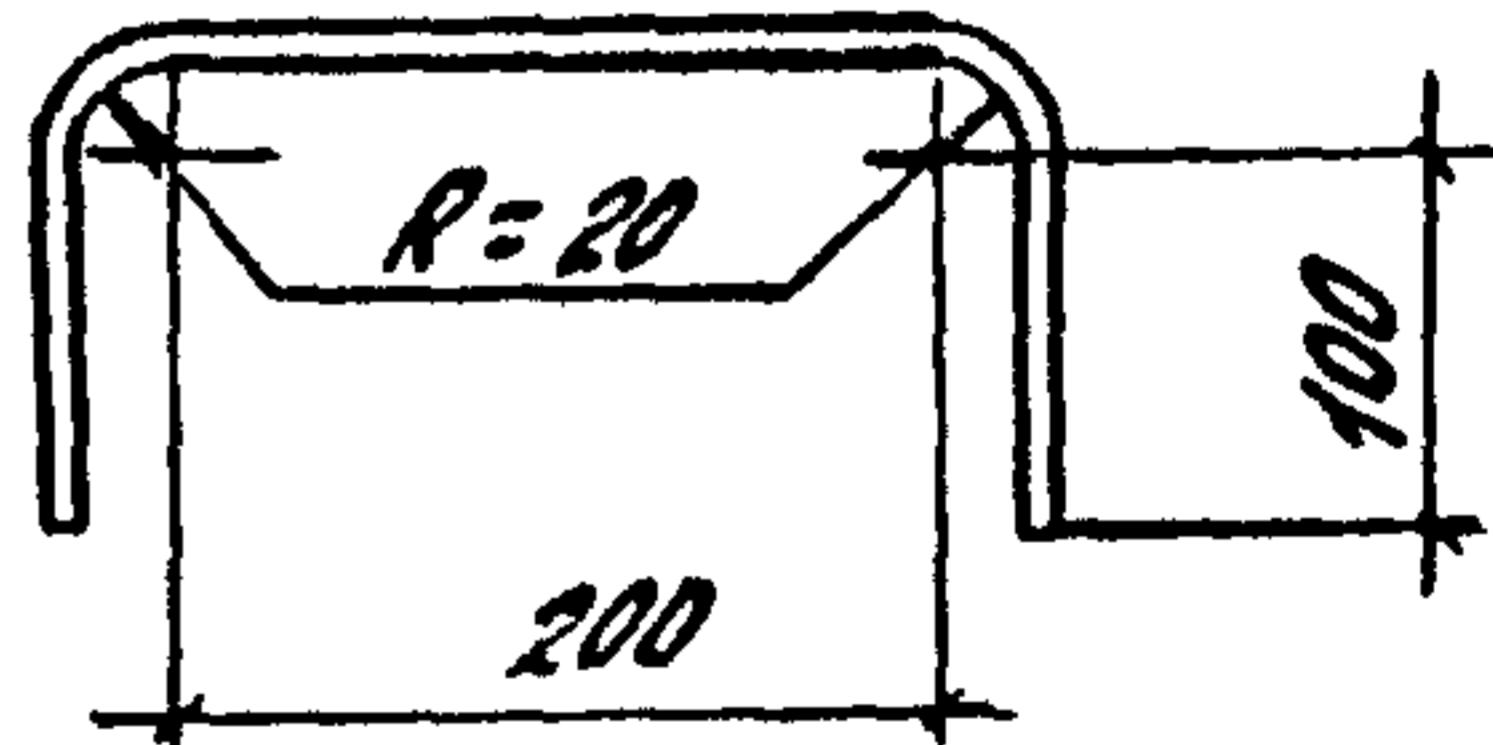
В настоящем примере даны варианты образования пространственных каркасов без применения электросварочных клещей с помощью скоб, привариваемых к электродам типа Э42А к поперечным стержням плоских каркасов ригелей рядовых, торцевых и у температурного шва, а также ригелей, воспринимающих односторонние приложенные нагрузки (односторонне поперечного сечения) для зданий с сеткой колонн 12x6 м.
